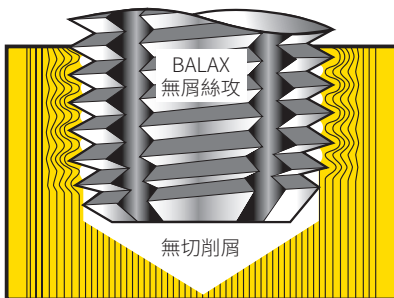
無屑絲攻重新排列材料的晶粒，無切削屑
